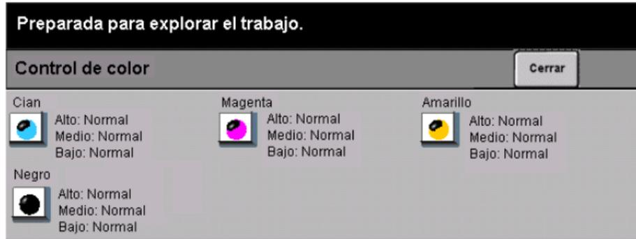
Utilice esta función para ajustar el equilibrio entre colores y la cantidad de color de la salida utilizando los botones de desplazamiento de cada color.
