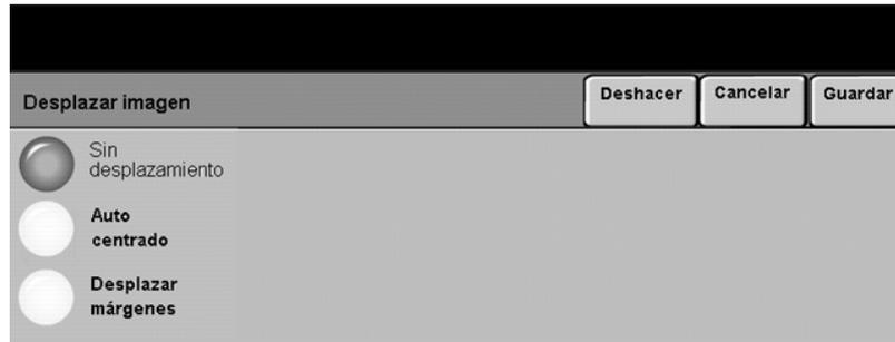
Esta función le permite controlar la posición de la imagen en la copia (salida).
