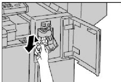
3. Håll i den orangefärgade spaken på häftklammerkassetten och ta ut den ur efterbehandlaren.
