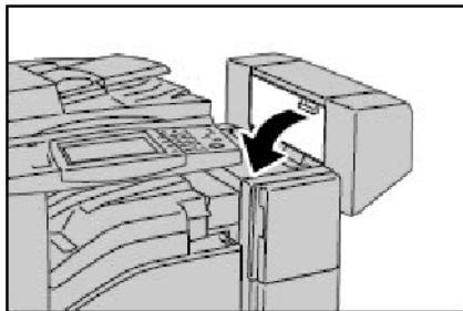
1. Kontrollera att maskinen har stoppats och öppna efterbehandlarens sidolucka.
