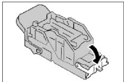
6. Tryck ned den främre spaken på häftklammerkassetten tills den snäpps fast på plats.
