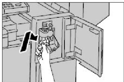
7. Håll i den orangefärgade spaken på häftklammerkassetten och sätt tillbaka kassetten i ursprungsläget.
