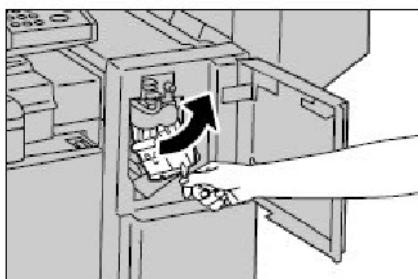
2. Håll i spak R1 på häftklammerkassetten och skjut kassetten åt höger.
