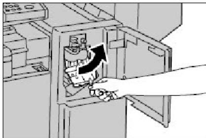
2. Håll i spak R1 på häftklammerkassetten och skjut den åt höger.
