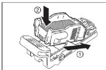
5. För in den främre delen på den nya häftklammersatsen i häftklammerkassetten och skjut sedan in den bakre delen i kassetten.
