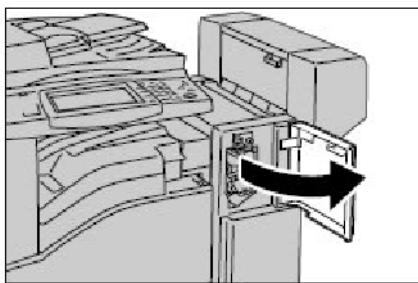
1. Kontrollera att maskinen inte är igång och öppna efterbehandlarens frontlucka.
