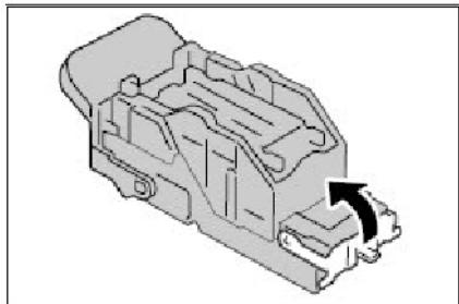
4. Skjut upp den främre spaken på häftklammerkassetten.
