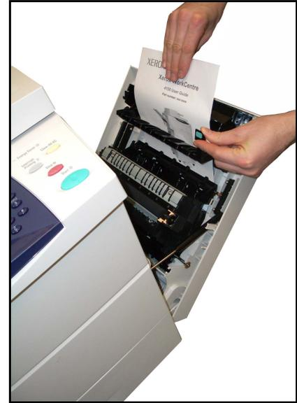
2. Asegúrese de que todos los asideros y palancas vuelvan a colocarse en la posición correcta.
