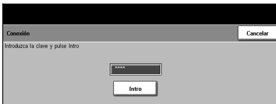
**NOTA:** **1111** es la clave prefijada de fábrica. Se recomienda cambiarla. Para obtener información sobre cómo cambiar las claves, seleccione el botón **Ayuda** del teclado numérico de la máquina.
