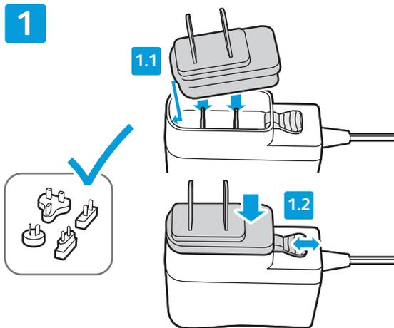
Choisissez et installez l'un des adaptateurs secteur (CA) sur le bloc d'alimentation 5 VCC. Vérifiez que l'adaptateur s'enclenche correctement dans la base.
