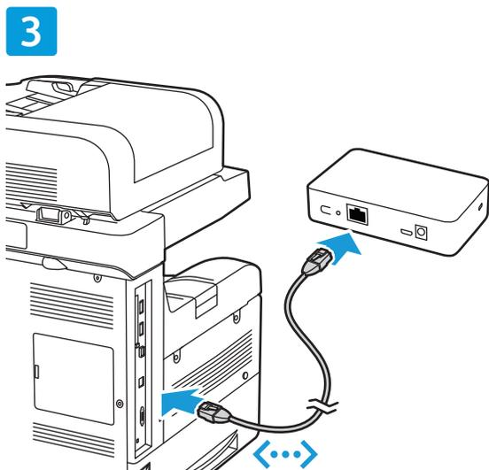
Raccordez le câble Ethernet à votre imprimante et à l'adaptateur de solutions d'impression sans fil.
