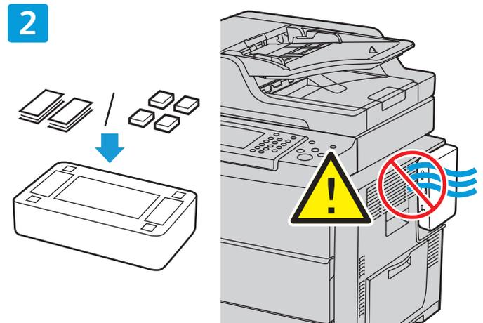
Placez les pieds en caoutchouc ou les bandes velcro sous l'adaptateur. Si vous fixez l'adaptateur à l'imprimante, veillez à ne pas obstruer les grilles de ventilation ou les portes d'accès.
