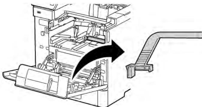
5. Die beiden Griffe zusammendrücken, um das Reinigungspolster vom Reinigungsstab zu lösen. Das gebrauchte Reinigungspolster ordnungsgemäß recyceln.
