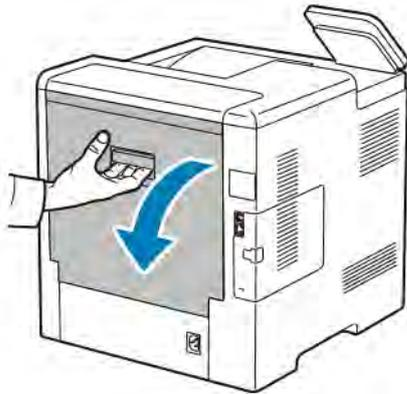
2. Zum Öffnen der Materialführung oben an der Fixieranlage den Griff an der Materialführung nach oben ziehen.
