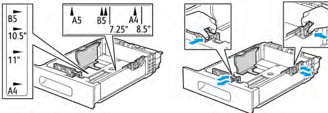
3. Um für Material im Format Legal die Behältervorderseite zu erweitern, den grünen Entriegelungshebel drücken und den Behälter herausziehen.
