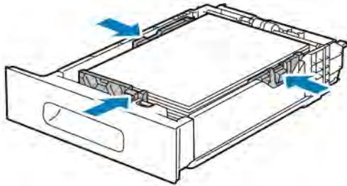
7. Behälter in das Gerät einsetzen.
