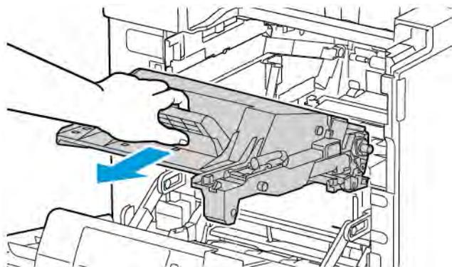
4. Den Reinigungsstab an der Innenseite der vorderen Abdeckung entnehmen.
