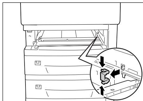
4. Dégagez la languette supérieure de l'attache située sur le côté intérieur gauche de l'imprimante. Faites basculer la languette vers l'intérieur de l'imprimante.
