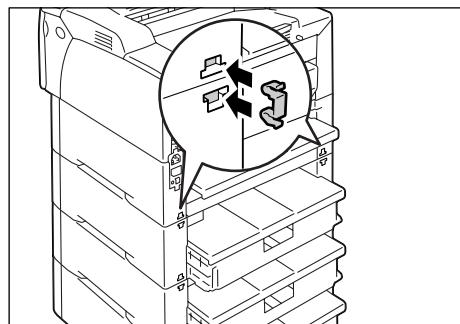
11. Задвиньте лоток обратно в принтер. Лоток нужно задвинуть до упора.
