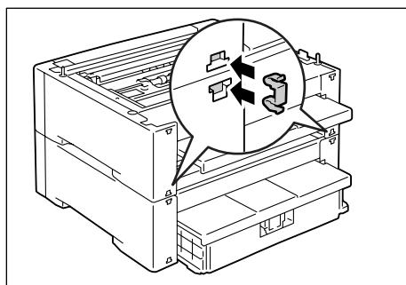
6. Задвиньте лоток обратно в верхнее устройство подачи. Лоток нужно задвинуть до упора.
