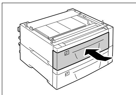
7. Повторите действия пунктов 3–6, чтобы установить другое устройство подачи сверху этих двух устройств.
