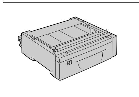
3. Alinee las esquinas de los alimentadores de hojas superior e inferior. Ponga cuidadosamente el alimentador de hojas superior sobre el alimentador inferior, colocando los orificios de la parte inferior del alimentador superior sobre las tres clavijas que hay en el alimentador de hojas inferior.
