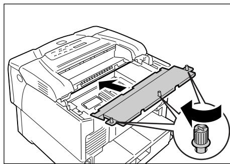
10. Вставьте в принтер заднюю крышку и закрепите двумя винтами, вывернутыми при выполнении пункта 2.
