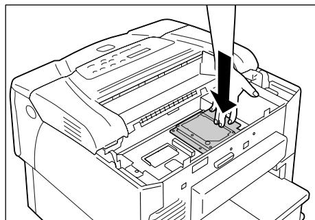
8. Вкрутите рукой два винта (из комплекта поставки) снаружи принтера и закрепите жесткий диск на плате контроллера.
