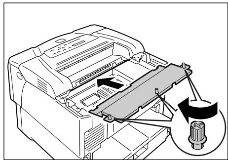
10. Ré-installez le capot arrière sur l'imprimante en resserrant les deux vis enlevées à l'étape 2.
