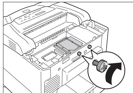
9. Ré-installez la plaque métallique sur l'imprimante en resserrant les trois vis dévissées à l'étape 4.
