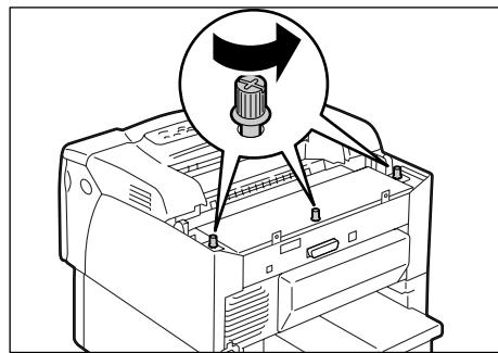
6. Вытяните металлическую пластину вперед и снимите её с принтера.
