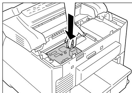
9. Fije la tarjeta, apretando a mano los dos tornillos (incluidos) en la parte externa de la impresora.
