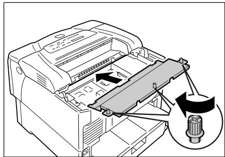
11. Vuelva a instalar la puerta posterior en la impresora, apretando los dos tornillos que retiró en el paso 2.
