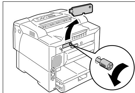
3. Retire los dos tornillos que aseguran la puerta posterior a la impresora.
