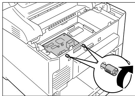
10. Вставьте в принтер металлическую пластину и закрепите тремя винтами, вывернутыми при выполнении пункта 4.
