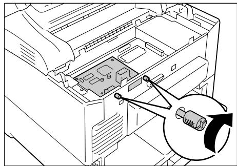
10. Vuelva a instalar la tapa metálica en la impresora, apretando los tres tornillos que aflojó en el paso 4.
