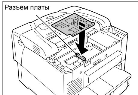
8. Нажмите на сетевую плату расширения, как показано на рисунке, и плотно вставьте её разъем. Для надежной установки может потребоваться слегка покачать плату.
