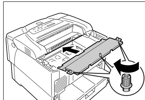
11. Ré-installez le capot arrière sur l'imprimante en resserrant les deux vis enlevées à l'étape 2.
