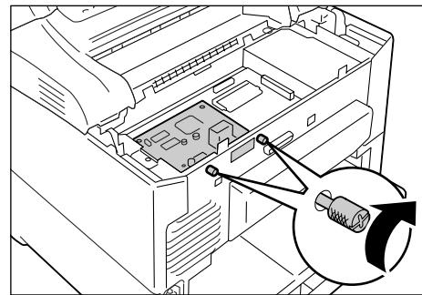
10. Ré-installez la plaque métallique sur l'imprimante en resserrant les trois vis dévissées à l'étape 4.
