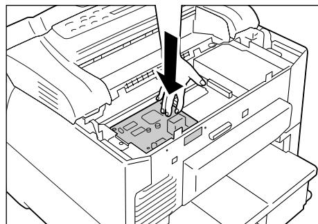
9. Закрепите плату, вкрутив рукой два винта (из комплекта поставки) снаружи принтера.
