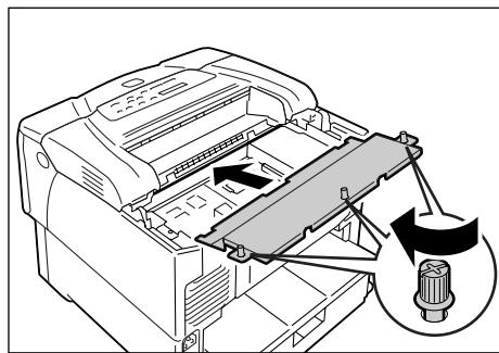
11. Вставьте в принтер заднюю крышку и закрепите двумя винтами, вывернутыми при выполнении пункта 2.
