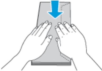
3. Die Umschläge mit der zu bedruckenden Seite nach oben und geschlossenen Klappen so in die Zusatzzufuhr einlegen, dass die Klappen unten und links zu liegen kommen.
