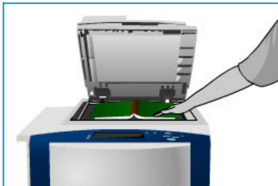
Das Format der Vorlage wird beim Scannen ermittelt. Verfügen die Seiten über einen dunklen Rand, wird dieser Rand nicht als Teil der Seite erkannt. In diesem Fall das genaue Format der Seiten eingeben. Dazu
