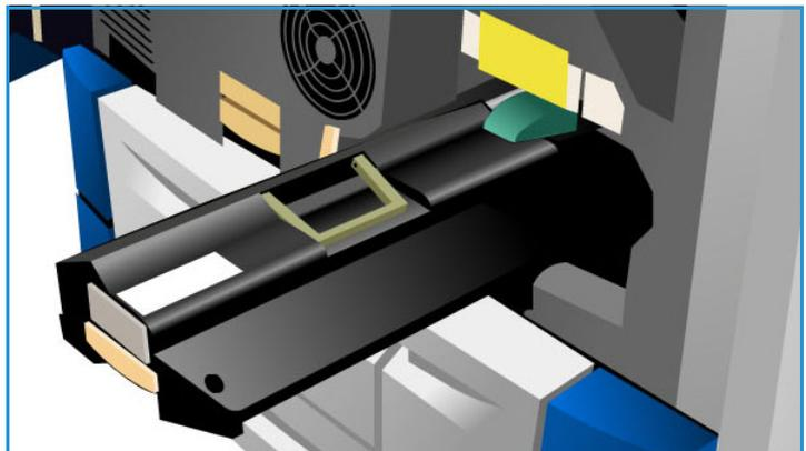
Die Einheit nach den Anweisungen am Touchscreen und in der Verpackung der neuen Einheit auswechseln. Die alte Einheit nach Anweisung auf der Packung oder des Xerox Partners entsorgen.
