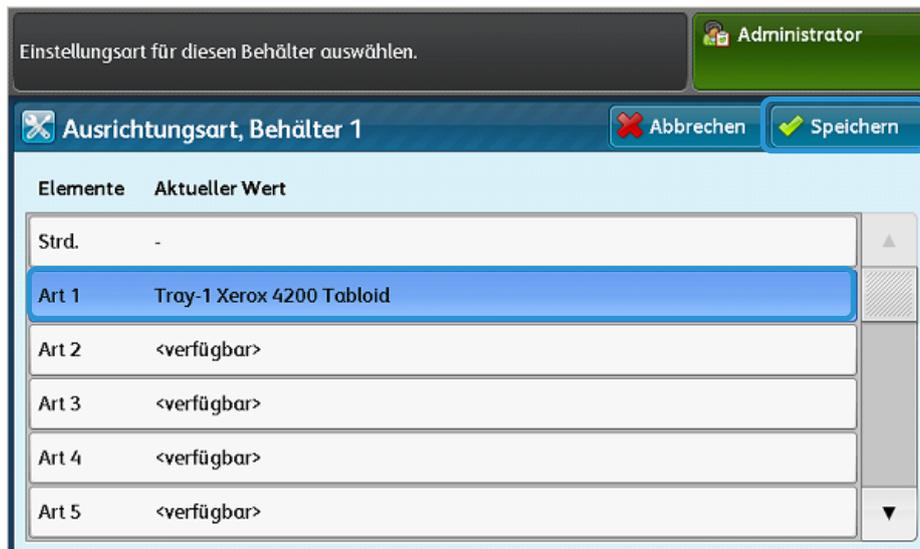
Diese Art ist damit dem in Schritt 33 ausgewählten Materialbehälter zugeordnet.
