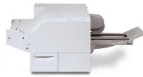
Ce périphérique de finition en option est utilisé avec un module de finition doté d'une plieuse/brocheuse. Le cahier est assemblé et agrafé dans la zone plieuse/brocheuse du module de finition et, par conséquent, il entre dans le module massicot SquareFold déjà assemblé.
