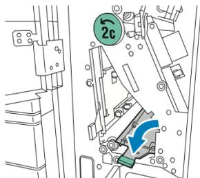
5. Fermer le bac de la plieuse et fermer ensuite la porte avant de la plieuse C/Z.
