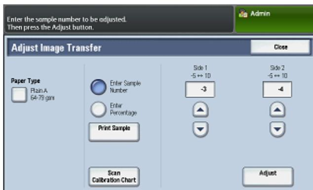
**Bildschirm 'Bildübertragung einstellen' zeigt maschinengewählte Werte für Seite 1 und Seite 2 nach Kalibrierung**
