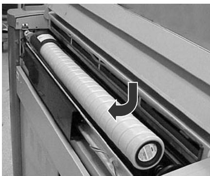
11. Installer la nouvelle cartouche de toner pour que l'extrémité contenant le ruban de couverture soit face à l'avant de l'imprimante.
