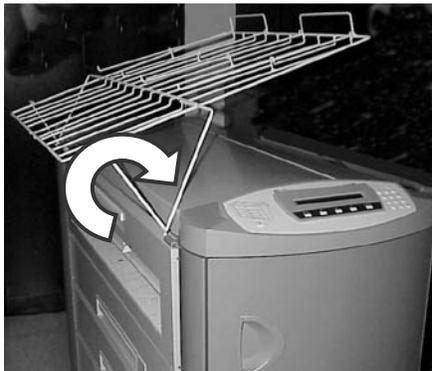
**AVERTISSEMENT** : Ne pas toucher le rouleau du module four tout en dégageant un incident support dans la zone du module four. Le rouleau du module four est très chaud et peut causer de sévères brûlures.
