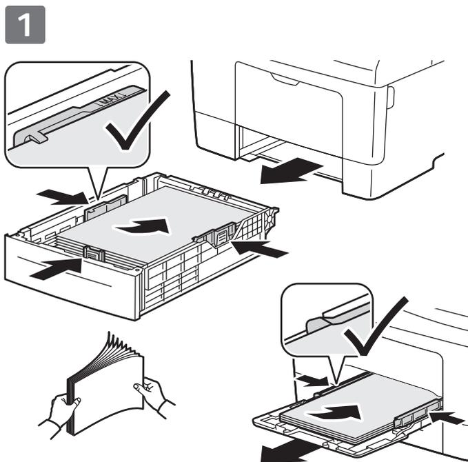
Pour obtenir les meilleurs résultats, ventilez les bords du papier. Réglez les guides en fonction du format de papier. Ne chargez pas de papier au-dessus de la ligne de remplissage maximal.
