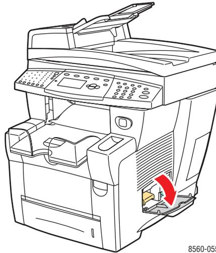
2. Extraiga el kit de mantenimiento (con la etiqueta A) de la ranura del kit de mantenimiento.
