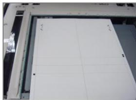
2. Ouvrir le panneau du chargeur automatique de documents. Noter que le panneau de commande affiche maintenant l'écran Ajustement d'alignement auto. Les instructions sur cet écran sont utiles pour effectuer les quelques étapes suivantes. Noter dans le bas à droite de l'écran : Numériser les pages : 0.
