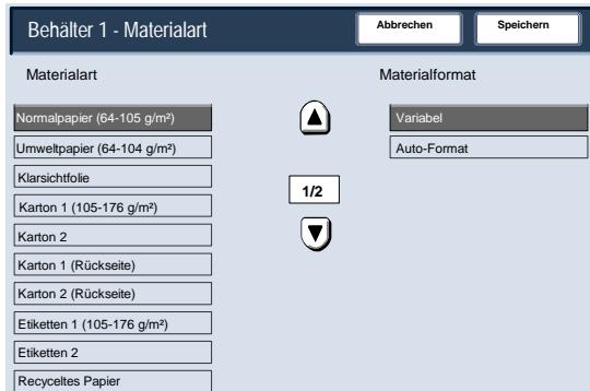
In der Anzeige **Variabel** wird angegeben, welches (Sonder-)Format das eingelegte Material aufweist. Die x- und y-Werte für das eingelegte Material lassen sich mit den Pfeiltasten auf dem Touchscreen ändern. Nach Angabe des neuen Materialformats **Speichern** antippen.
