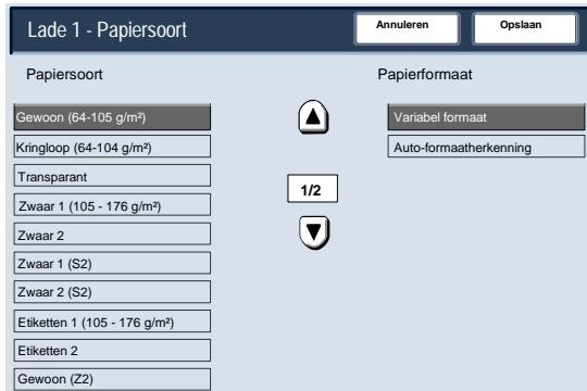
In het scherm **Variabel formaat** kunt u het exacte formaat opgeven van het papier dat u in de papierlade heeft geplaatst. Gebruik de pijltjes in het aanraakscherm om de waarden voor de X- en Y-as van het geplaatste papier te wijzigen.
