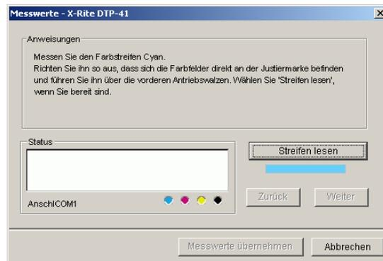
Richten Sie die Messwerteseite so im Führungsschlitz aus, dass der jeweils zu messende Farbstreifen unter der Justiermarke zentriert ist. Führen Sie die Messwerteseite über die vorderen Walzen in das Instrument ein, bis sie an die hinteren Antriebswalzen stößt (etwa 7 cm) und Sie einen Widerstand spüren.
