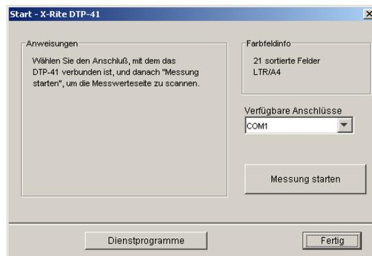
**10 Führen Sie die Messwerteseite in das DTP41 ein; messen Sie zuerst den Cyan-Farbstreifen.**
