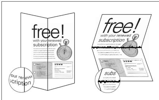
L'une des méthodes utilisées pour déterminer le grain consiste à plier une feuille dans le sens de la longueur, puis dans le sens de la largeur. Comparez ensuite les deux plis. Plié dans le sens des fibres, le papier présente un pli lisse, sinon, il présente un pli irrégulier.
