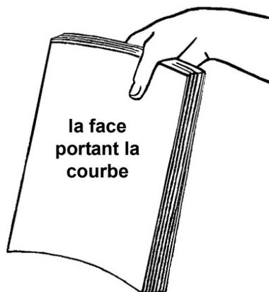
Si l'emballage de la rame de papier ne porte aucune flèche, la face se trouvant au contact de la fermeture de l'emballage ne porte pas la courbe. Vous pouvez également déterminer la face portant la courbe en effectuant le petit test ci-dessous.
