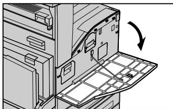
2. Aprire il vassoio 5 (bypass) e alzare la leva di rilascio per aprire la copertura A.
