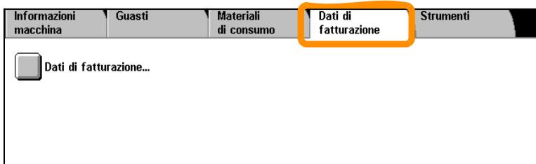
3. Selezionare [Dati di fatturazione]. Viene visualizzato il Contatore.
