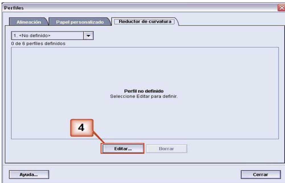
5. Hay curvatura después de haber intentado con el valor prefijado del sistema y los ajustes de A a D. [Consulte "Ajustes A - D del perfil del reductor de curvatura" en página 3.](#) Entonces, debe programar el reductor de curvatura para usar presión hacia arriba (o el rodillo superior) para eliminar la curvatura hacia arriba (en forma de copa).
