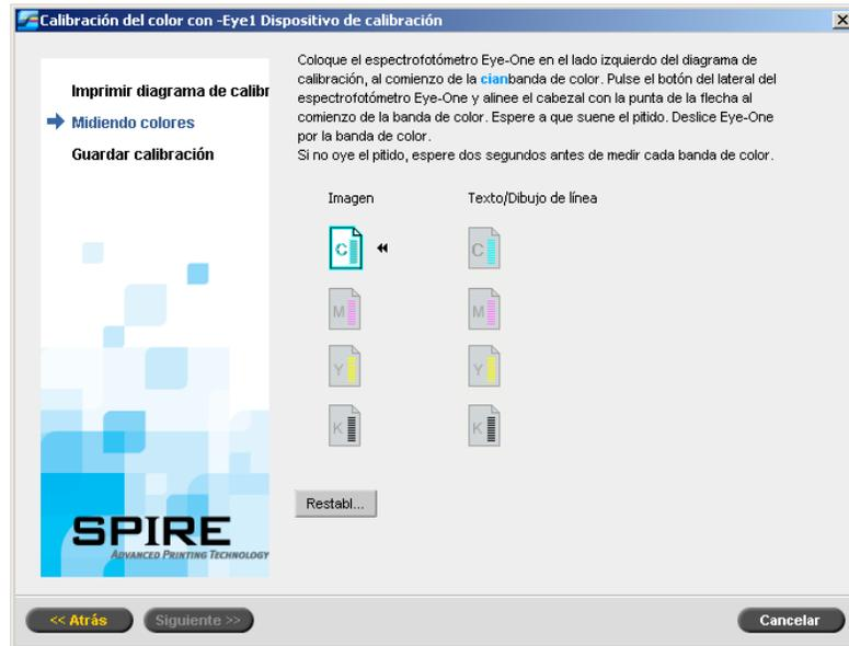
11. Mantenga presionado el botón del lateral y alinee el cabezal con la punta de la flecha cyan. La flecha está situada a la izquierda de la columna cyan en el diagrama de calibración de densidad de imagen. Esta punta se cruza con la línea semi-punteada.
