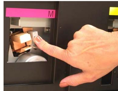
4. S'assurer que l'unité de corotron et la baguette de nettoyage sont correctement en place.
