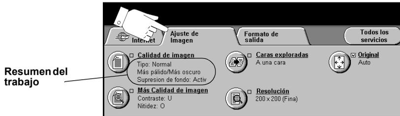
Pulse cualquiera de los botones de la parte superior para seleccionar una función. Para ver todas las opciones de una función, seleccione la función que corresponda. De ser necesario, es posible seleccionar varias opciones para cada trabajo de fax.
