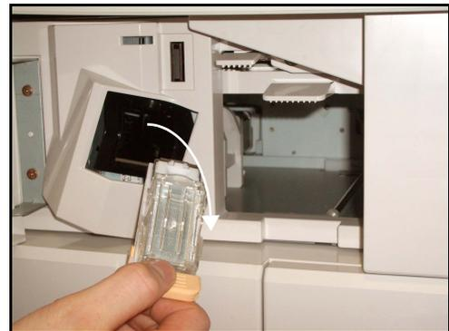
3. Das leere Heftklammerpaket aus dem Magazin heben.
