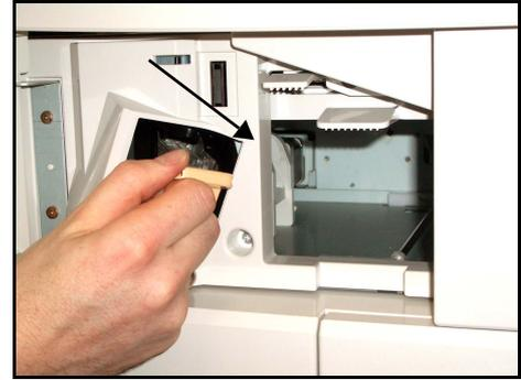
2. An der Verriegelung ziehen, um das Heftklammermagazin zu entfernen.
