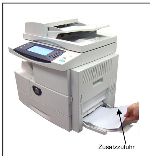
4. Materialführungen auf die Breite des Druckmaterials einstellen. Darauf achten, dass nicht zu viel Material eingelegt wird. Der Stapel darf höchstens bis zur Markierung für den maximalen Füllstand reichen.
