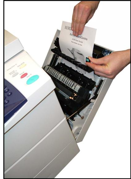
2. Sicherstellen, dass sich alle bei der Behebung eines Materialstaus betätigten Handgriffe und Hebel anschließend wieder in der korrekten Position befinden.
