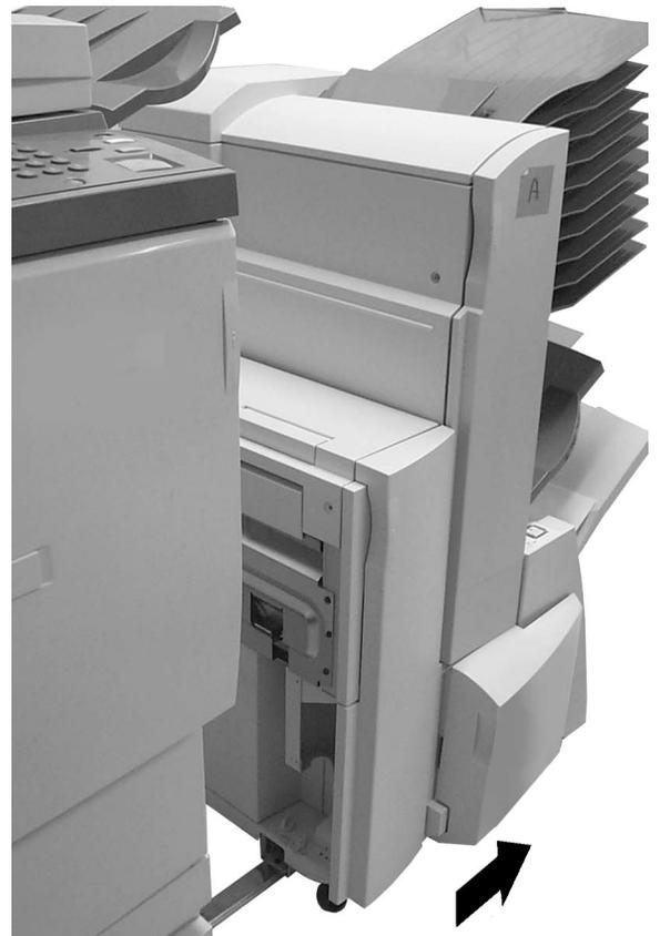
**Abbildung 9: Finisher vom Kopierer/Drucker wegschieben**
