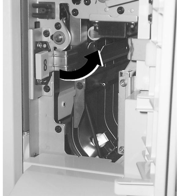
**Abbildung 16: Hebel 8 nach rechts drehen**
