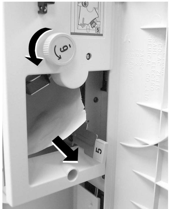
Abbildung 13: Knopf 6 drehen und gestautes Papier entfernen
