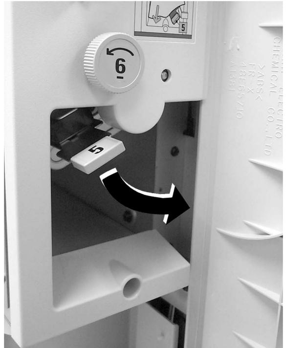
Abbildung 12: Hebel 5 nach unten drehen
