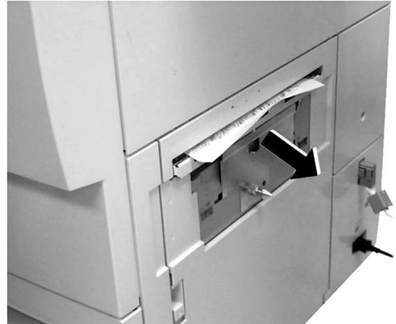
**Abbildung 10: Papier aus dem Schnittstellenbereich entfernen**
