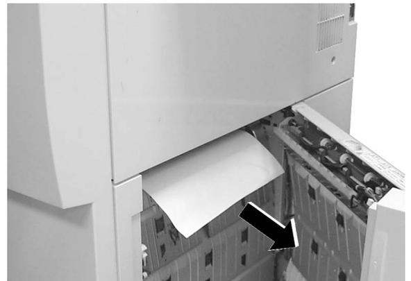
**Abbildung 11: Papier hinter der rechten Tür des Kopierers/Druckers entfernen**
