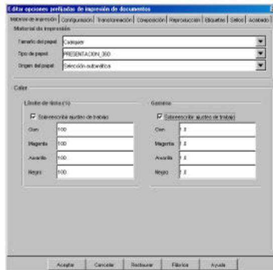
**Tamaño del papel** – seleccione el tamaño de papel apropiado para el trabajo de impresión. La opción CUALQUIER hace que la impresora seleccione el mejor tamaño de material de impresión según el tamaño de la imagen y el material de impresión instalado en la impresora. Cuando se selecciona un tamaño en específico, se activa la opción "Ajustar a tamaño" en el menú desplegable de la ficha de la ficha Transformación.
