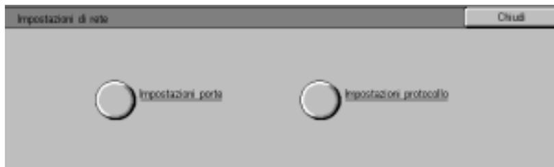
Le impostazioni di rete sono due: Impostazioni porte, che determina il tipo di interfaccia dell'unità principale collegata ai client, e Impostazioni protocollo, che determina la modalità di comunicazione.
