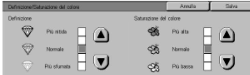
L'opzione Definizione consente di impostare il livello di definizione dei bordi dell'immagine sulle copie. La funzione Saturazione del colore consente di regolare l'intensità generale del colore sulle copie stampate. Sono disponibili cinque livelli di regolazione per ogni funzione.
