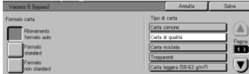
Quando si carica della carta nel vassoio 5, è necessario specificare sia il formato che il tipo di carta. Con i formati standard, è possibile utilizzare la funzione Rilevamento formato auto.
