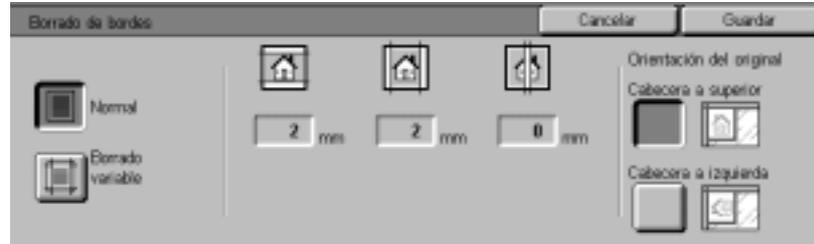
La función Borrado de bordes permite eliminar en la copia las marcas no deseadas próximas a los bordes del original. La escala para Borrado de bordes va de 0 a 50 mm en incrementos de 1 mm.
