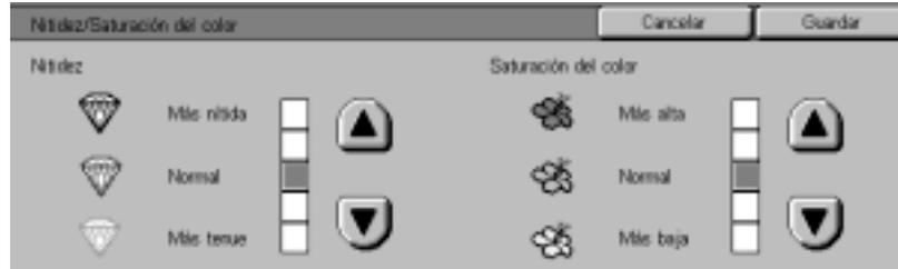
La función Nitidez permite ajustar la cantidad de definición de los bordes en las copias. La función Saturación del color permite ajustar la intensidad general del color en la copia. Hay cinco niveles de ajuste para cada función.
