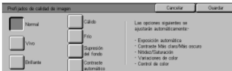
La función Prefijados de calidad de imagen cambia automáticamente las opciones de Calidad de imagen para producir varios efectos predeterminados.
