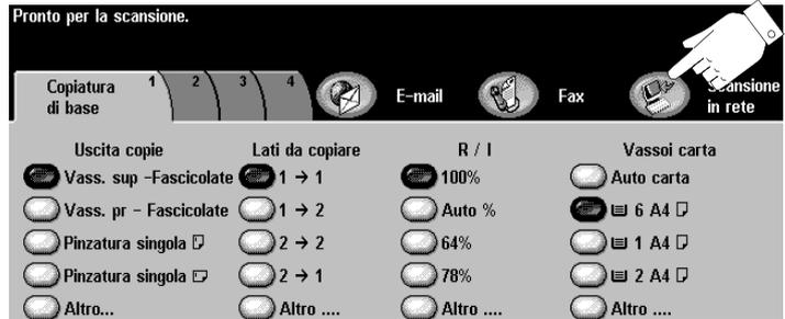
Selezionare il pulsante *Scansione in rete*. Se Autenticazione è attiva, è necessario completare la sequenza di login. Ricordarsi di uscire dalla funzione per evitarne l'accesso non autorizzato.
