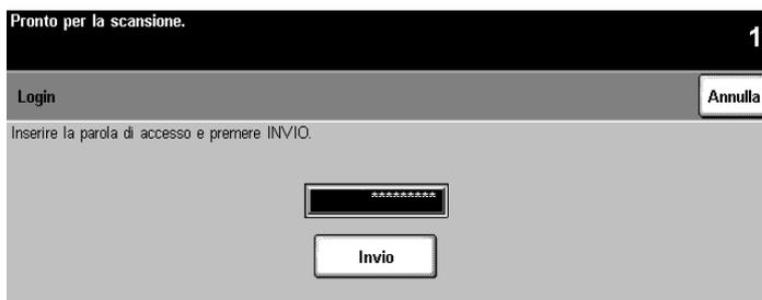
Il sistema è dotato di una funzione standard conosciuta come Auditron interno, che consente di controllare l'accesso alla macchina e registrare il numero di copie effettuate da ciascun utente.
