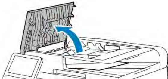
2. Ako se papir zaglavio u sklopu za jednoprolezno dvostruko automatsko ulaganje dokumenata, otvorite poklopac radne površine i uklonite sav zaglavljeni papir.
