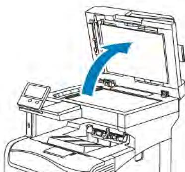
4. Obrišite površine stakla za polaganje dokumenta dok nisu čiste i suhe.
