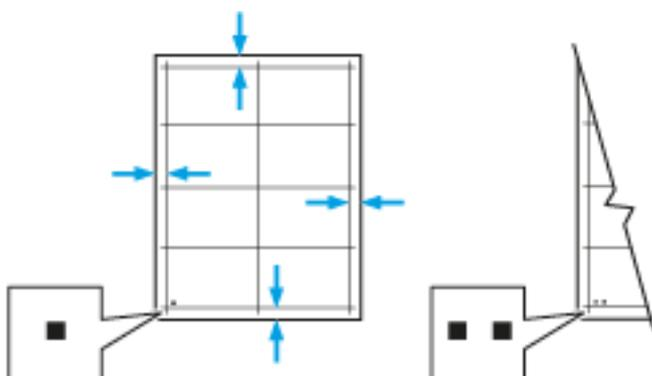
10. Pour le verso, mesurez la distance entre l'image imprimée et les bords supérieur, inférieur, gauche et droit.
