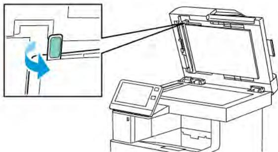
8. À l'aide d'un chiffon doux humecté d'eau, essuyez la vitre miroir, la bande plastique blanche et les rouleaux. Si vous avez du mal à enlever les salissures, humectez un chiffon doux avec une petite quantité de détergent neutre et essuyez les différentes parties de l'imprimante avec un chiffon doux.
