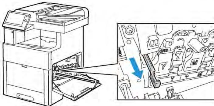
7. Insérez la tige de nettoyage dans l'un des quatre trous de nettoyage jusqu'à ce qu'elle ne puisse pas aller plus loin, puis ressortez-la en tirant dessus. Répétez cette opération deux fois.
