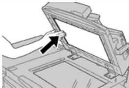
Wenn die Vorlagenabdeckung mit bloßen Händen berührt wurde, sollte sie abgewischt werden, bevor der Vorlageneinzug geschlossen wird.
