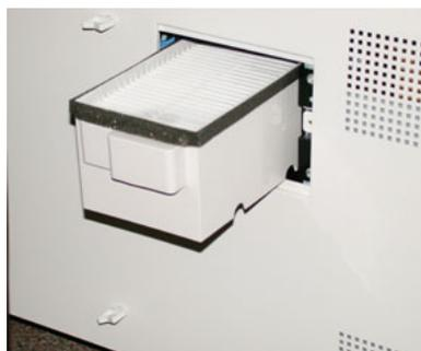
5. Entfernen Sie den Ansaugfilter aus dem Gehäuse.
