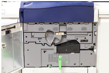
3. Drehen Sie den Griff **R1-R4** der Trommeleinheit in die Entriegelungsposition.
