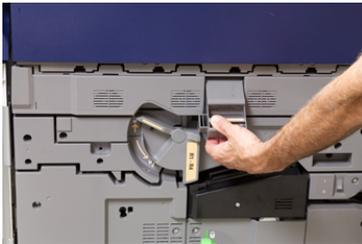
7. Entfernen Sie die alte Trommeleinheit, indem Sie Ihre Finger durch die Fingerringe an beiden Enden der Einheit stecken und sie sanft anheben.
