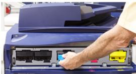
4. Entfernen Sie den Tonerbehälter, indem Sie ihn langsam, sanft und gerade herausziehen. Halten Sie beim Herausziehen die Unterseite des Behälters mit Ihrer anderen Hand fest.
