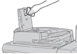
3. Die obere Abdeckung des Vorlageneinzugs schließen, bis ein Einrasten zu hören ist.
