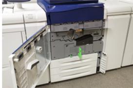
2. Den **Griff 2** nach rechts drehen, bis er sich in waagerechter Position befindet, und dann das Übertragungsmodul herausziehen.
