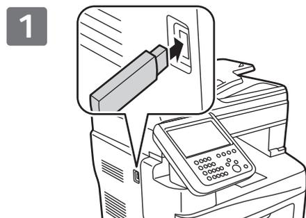
USB-Laufwerk am USB-Port anschließen
