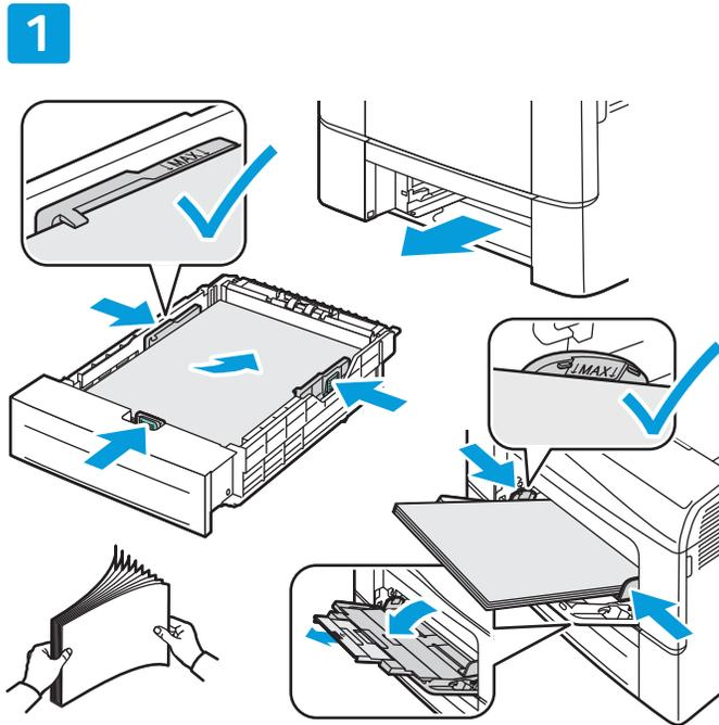
Für optimale Ergebnisse das Druckmaterial auffächern. Führungen an das Materialformat anpassen. Füllhöhenmarkierung nicht überschreiten.
