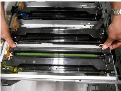
**10.** Сразу же закройте секцию принт-картриджей, чтобы защитить другие картриджи от воздействия света.
