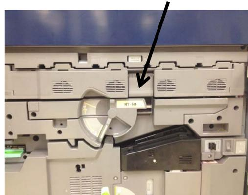
7. Для извлечения старого принт-картриджа встаньте слева от секции принт-картриджей.
