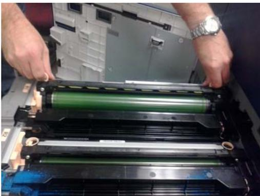
**9.** Нажмите на оба конца принт-картриджа **одновременно**, чтобы зафиксировать его **в горизонтальном положении**.
