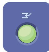
**Druckunterbrechung** unterbricht den aktuellen Auftrag bzw. setzt ihn fort.
