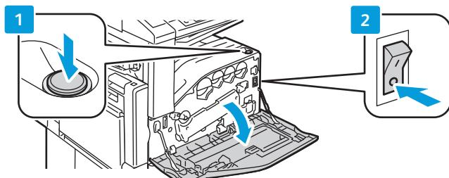
Chcete-li tiskárnu restartovat, použijte **sekundární vypínač** na horní straně tiskárny. Pokud chcete tiskárnu úplně vypnout, vypněte ji **sekundárním vypínačem** a potom **hlavním vypínačem**, který se nachází za předním krytem.
