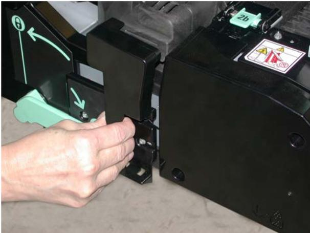
5. Levante la palanca de color ámbar solamente y levante y extraiga el módulo de transferencia.
