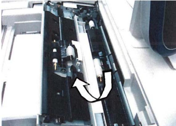
3. Apriete la palanca metálica para sustituir el rodillo de alimentación.
