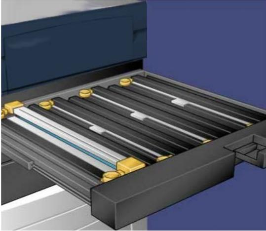
8. Para extraer el cartucho de cilindro viejo, sujete las argollas de los extremos del cartucho de cilindro y levántelo con cuidado.
