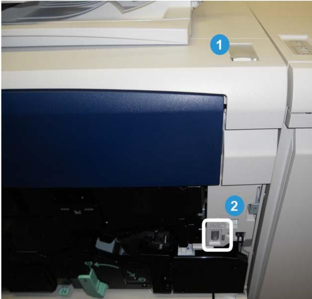
La machine a deux interrupteurs d'alimentation :
