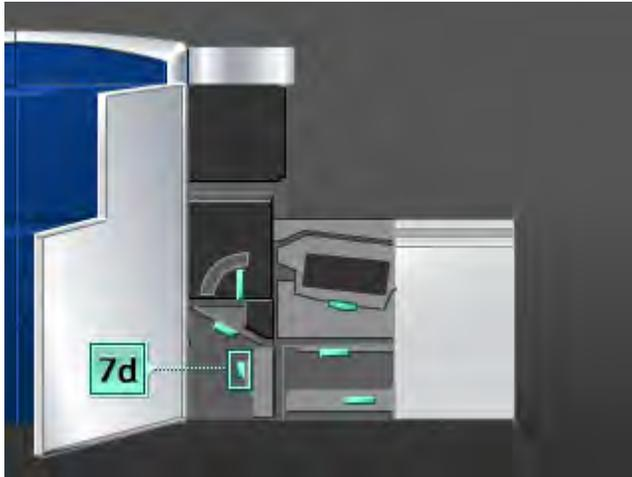
9. Utiliser un chiffon humide, humecté avec de l'eau (non mouillé), non pelucheux, pour nettoyer le circuit support uniquement dans les zones de dégagement d'incident du levier vert, comme indiqué ci-dessous.
