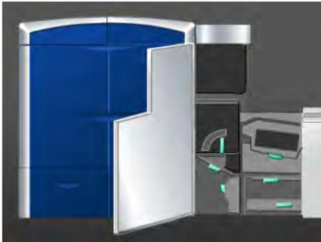
2. Saisir la poignée 5 et la tourner dans la direction de la flèche et tirer doucement sur le module four pour le sortir.
