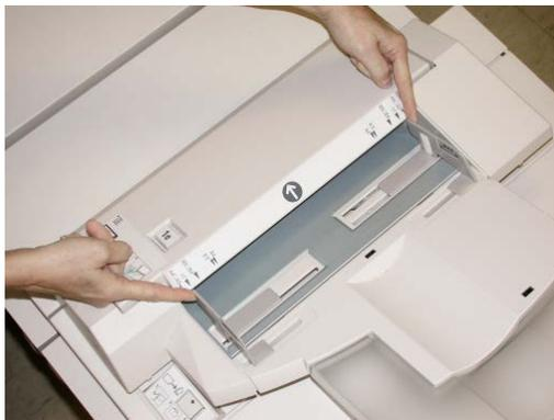
3. Material/Registmaterial einlegen und an der Behältervorderseite ausrichten.
