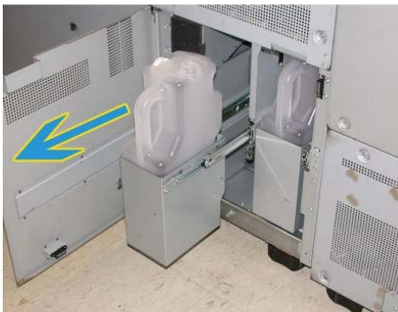
3. Den vollen Behälter aus der Maschine heben.
