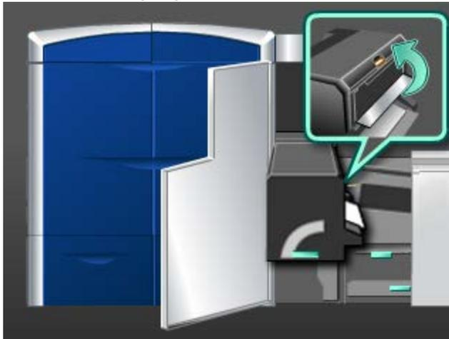
8. Griff 5 fassen und den Fixierer langsam bis zum Anschlag hineinschieben.
