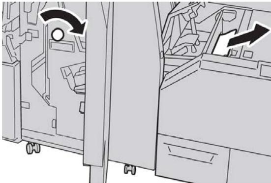
5. Die linke Abdeckung der Trimmer-Einheit schließen.
