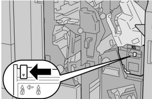
4. Pressione R5 conforme mostrado na figura e remova o recipiente de sobras de grampos da máquina.
