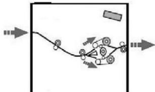
Quando o material entra no módulo, ele é alimentado no eliminador de curvatura do módulo para a correção de curvatura do papel. O eliminador de curvatura do módulo tem rolos superior e inferior de eliminação de curvatura que aplicam pressão ao material com base no seguinte:
