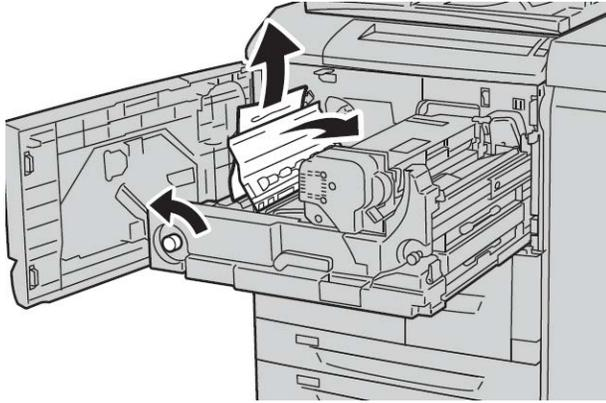
4. Se o papel estiver atolado na parte superior do módulo de transferência ou dentro da unidade de fusível, remova o papel ao puxá-lo para a esquerda. Se o papel não pode ser removido, erga a alavanca **2c** e então tente removê-lo.
