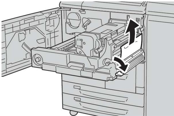
Se o papel atolado permanece dentro e está difícil de remover, puxe o módulo duplex para fora após retornar o módulo de transferência para a posição original. Então, tente novamente.
