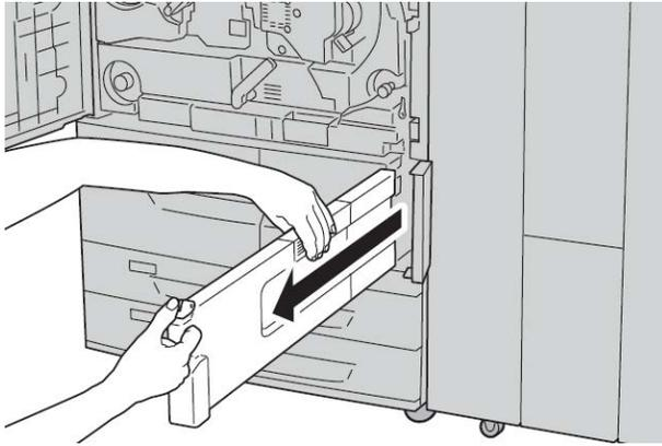
5. Segure firmemente o recipiente usado com ambas as mãos e coloque no saco plástico, fornecido com o novo recipiente. Feche o saco e descarte o recipiente, de acordo com os regulamentos locais.
