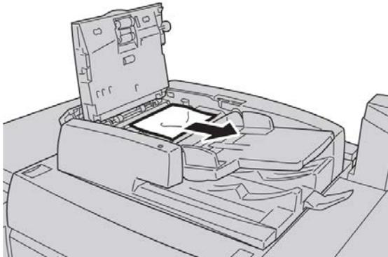
4. Se instruído para abrir a tampa interna, levante a alavanca e abra a tampa interna. Remova o documento atolado.
