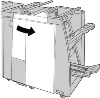
3. Localize o Recipiente de Sobras de Grampos (R5) no módulo de acabamento e mova a alavanca de travamento para a posição destravada.
