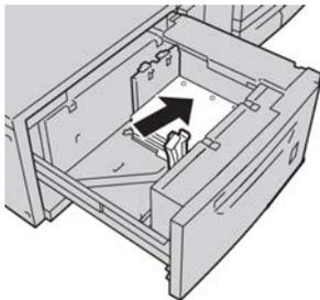
6. Ajuste as guias do papel pressionando a trava da guia e movendo a Guia da borda cuidadosamente até que ela encoste levemente na borda do material na bandeja. Não coloque os materiais acima da linha MAX localizada na Guia de borda traseira.
