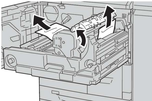
5. Erga a alavanca **2c** conforme necessário, mova a alavanca **2d** e então remova o papel atolado.
