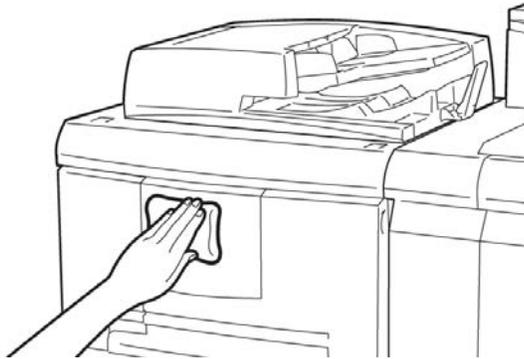
2. Remova qualquer excesso de água da parte externa com um pano macio.
