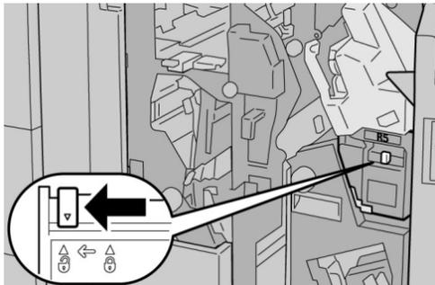
4. Pressione R5 conforme mostrado na figura e remova o recipiente de sobras de grampos da máquina.
