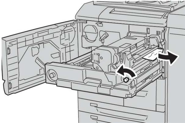
7. Mova a alavanca **3b** para a direita da unidade do fusível conforme necessário e então remova o papel atolado.
