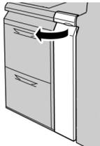
4. Retire el soporte para postales desde el interior de la cubierta delantera del OHCF.
