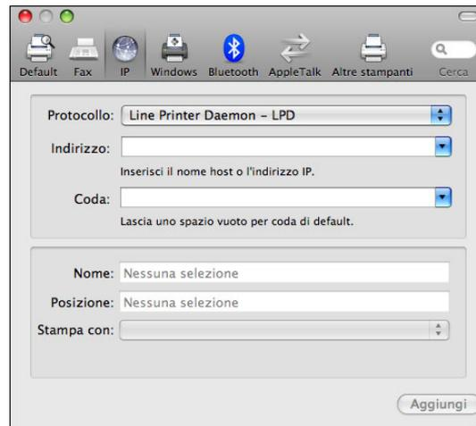
**2 Stampa LPD: selezionare Line Printer Daemon - LPD dall'elenco Protocollo e digitare l'indirizzo IP o il nome DNS di EX Print Server nel campo Indirizzo, quindi digitare il collegamento di stampa (print, hold o direct) nel campo Coda. Proseguire con il [passo 4](#).**
