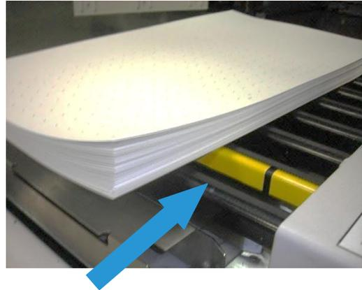
**Unterseite des gelben Ausrichtzinkens befindet sich oberhalb der Palettenfläche**
