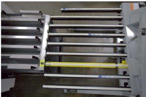
5. Ggf. die Wagenhöhe so justieren, dass die Zinken reibungslos in den XPS-Stapler eingreifen und den Materialstapel nicht beschädigen.
