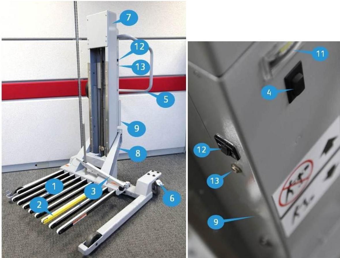
1. **Eingriffslose Stapelablage:** wird über die Handkurbel betrieben, sodass der Stapel an einen Arbeitstisch befördert werden kann.
