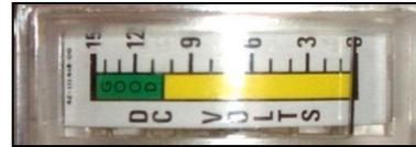
11. **Batterieanzeige:** zeigt die Batteriespannung an.
