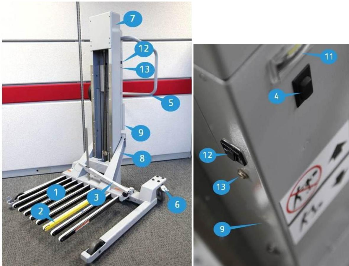
1. **HOST (Hands-Off Stack Transfer)** : activé au moyen de la manivelle de transport de la pile pour transférer la pile de papier sur une table de travail.
