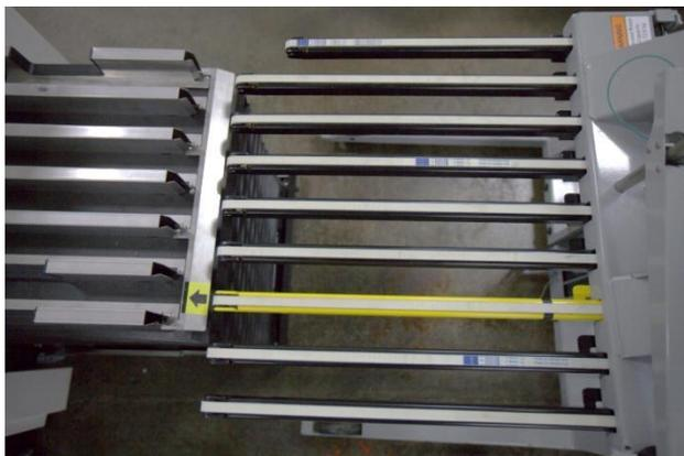
5. Effectuez des réglages de la hauteur du chariot pour être sûr que les dents sont dégagées du module XPS et du bas de la pile de papier.
