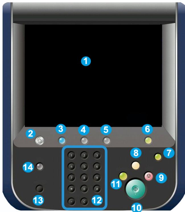
1. **Pantalla táctil.** La pantalla táctil permite seleccionar todas las funciones de programación disponibles. Además, muestra los procedimientos de solución de errores y la información general de la máquina.
