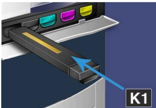
9. Cierre la cubierta del tóner. Si la cubierta no se cierra por completo, asegúrese de que el cartucho está en posición de bloqueo y de que está instalado en el lugar adecuado.
